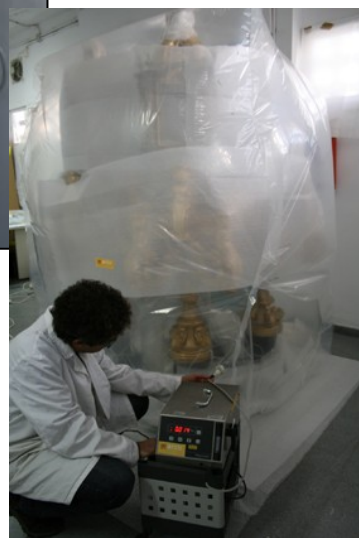
Medición concentración de oxígeno en el interior de la burbuja
