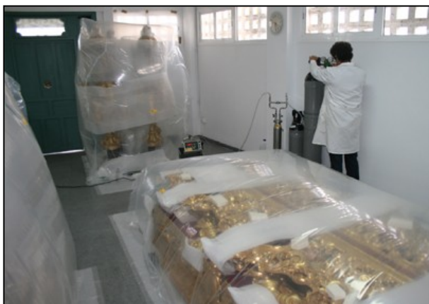
Inyección de nitrógeno en el interior de las burbujas
